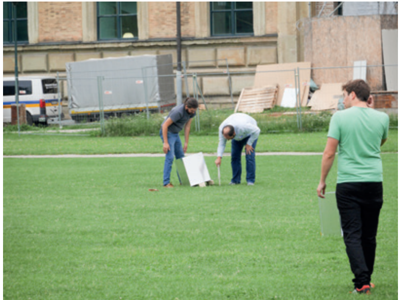
Die Reflektoren müssen genau positioniert und ausgerichtet sein. © Michael Eineder/DLR
