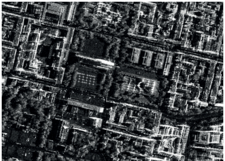
Es hat geklappt: Klar erkennbar formen die Corner-Reflektoren das TUM-Logo auf der südlichen Pinakothekswiese. © DLR 2018, TerraSAR-X Scientific Proposal NM_xiao.zhu_LAN2188
